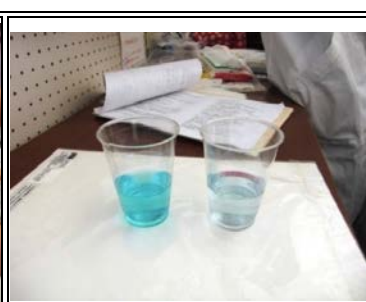
チタン塗布コップ（左） 光による劣化反応なし
