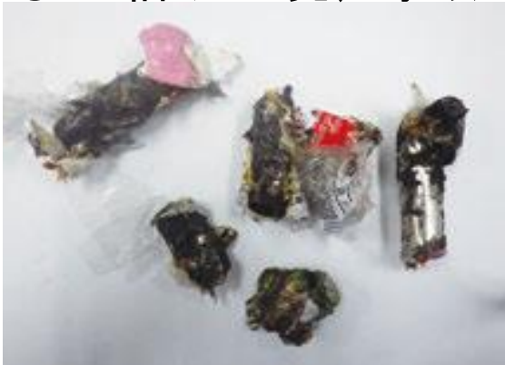
発火原因となったリチウムイオン電池
